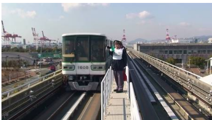
【故障列車と連結するため、救援列車に合図を送る係員の様子】
