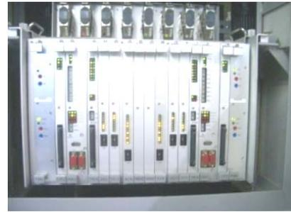
また、本装置には事故等発生時の事後要因解析のため、時間、速度、位置、力行指令、ブレーキ指令、自動列車制御装置（ATC）の動作等の情報について0.2秒ごとに24時間記録する運転状況記録機能を備えています。
