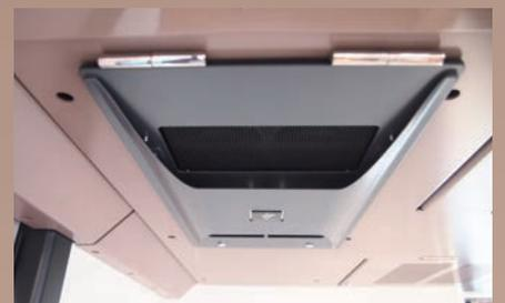
鉄道車両用プラズマクラスターイオン発生機を設置し衛生的な車内環境をご提供します。
