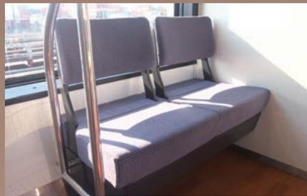
座席はご利用される方向士が気持ちよくお座りいただける個別タイプを設置しています。背もたれ背面は外光を取り入れて車内を明るくするために、開口を設けています。
